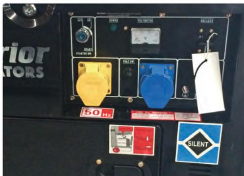
Anschlüsse: 1x 230V/32A, 1x 230V/16A
