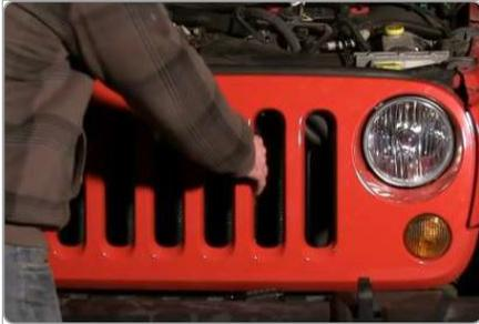
1) Entfernen Sie die Frontverkleidung
