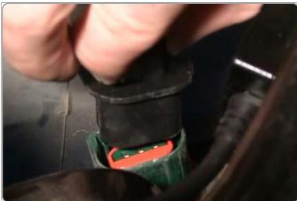
4) Entfernen Sie die Stecker und schließen Sie den neuen Scheinwerfer in umgekehrter Reihenfolge an.
